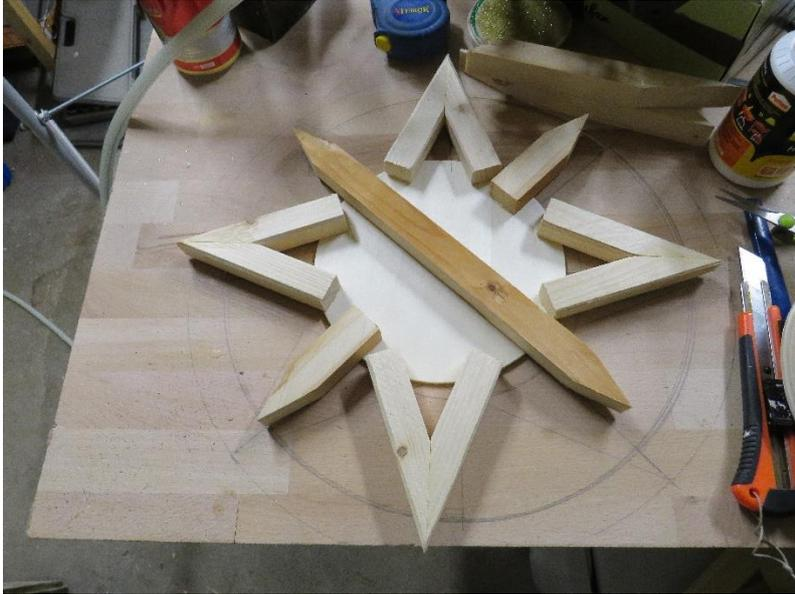
Auf diesen Mittelteil werden nun die Zacken und wenn gewünscht Strahlen aufgeklebt, verleimt und mit kleinen Nägeln zur Stabilität fixiert. Zuerst auf untere Scheibe oder Quadrat auflegen, einrichten, Leim auftragen. 2. Scheibe auflegen und fixieren.
